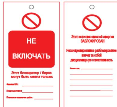
Рис. 2 Пример предупреждающей бирки (Tagout)
