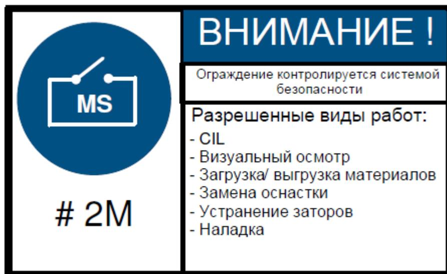
Рис. 4 Образец таблички «АМЕС»
